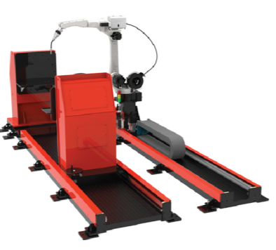
Робот на линии перемещения + перемещение ответной части позиционера
